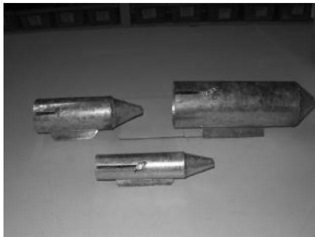
Figura 1. Tubos confeccionados com folha de zinco para imobilização dos animais do grupo experimental (Ex).
