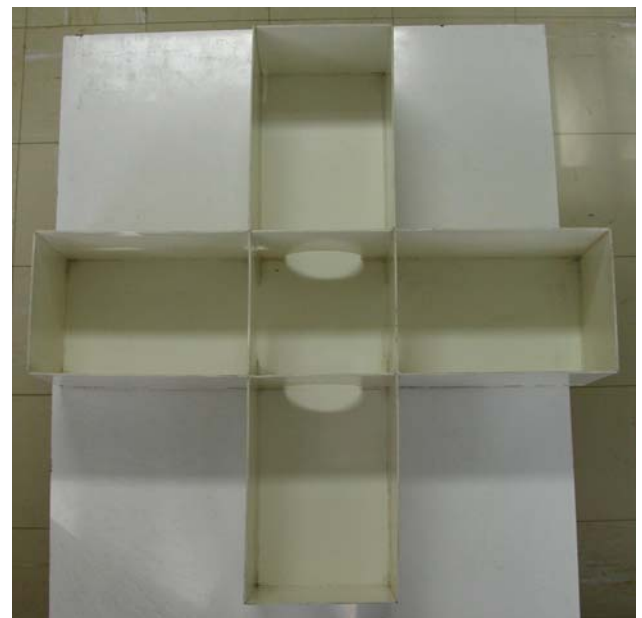
Figura 1. Aparelho para oferta simultânea de quatro fontes alimentares.
