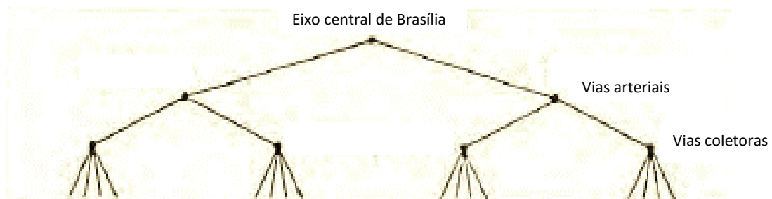
Figura 2: árvore de representação das vias da cidade brasileira planejada por Lucio Costa - Brasília. Fonte: Adaptada de Alexander (1965).
