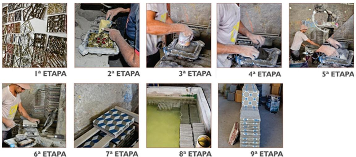
► Fig.6: Etapas da fabricação de um ladrilho hidráulico.
