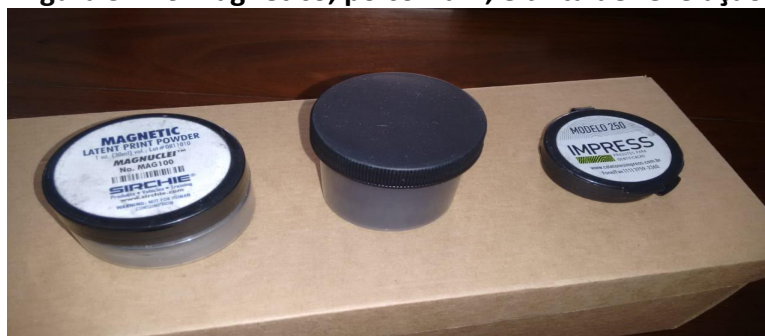
Figura 5 - Pó magnético, pó comum, e tinta de revelação
