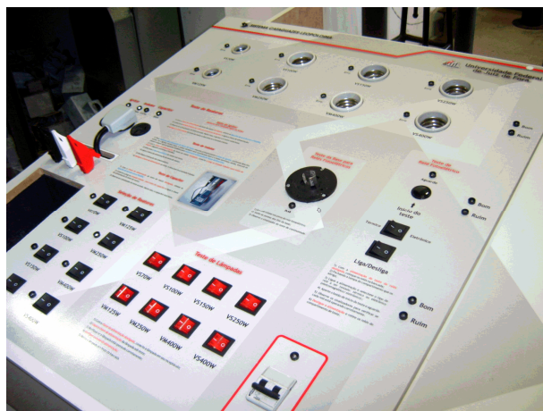
Figura 1 - Fotografia da bancada de testes de equipamentos de iluminação pública.
