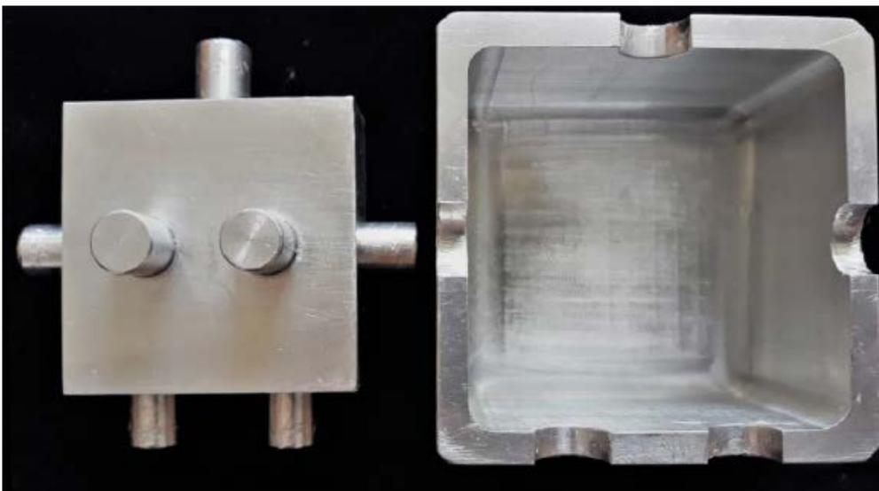
**Figura 3:** Imagem do modelo padrão metálico e moldeira metálica.
