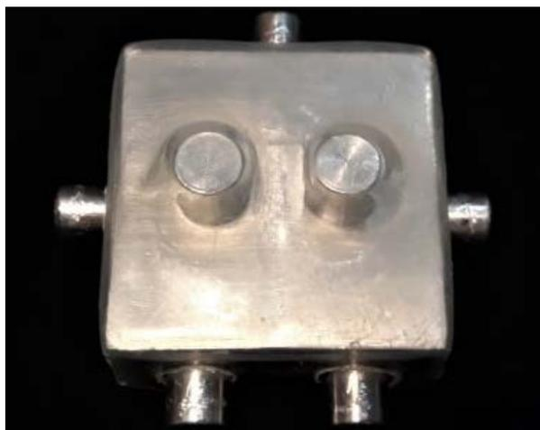
**Figura 6:** Alívio de 2mm com lâmina de polipropileno.
