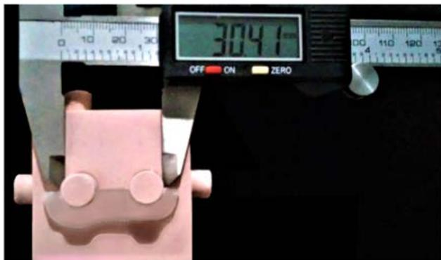
**Figura 9:** Dispositivo confeccionado de acrílico para padronização das medidas.
