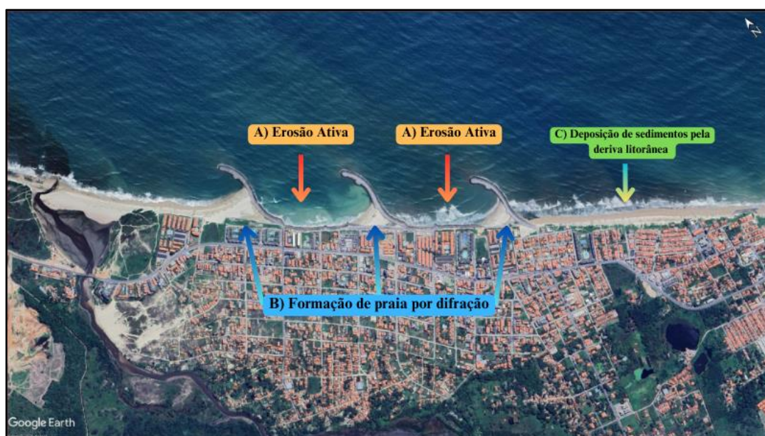
Figura 2. A) Erosão Ativa; B) Processo de difração; C) Processo de deriva litorânea. Fonte: Elaboração dos autores, 2024.
