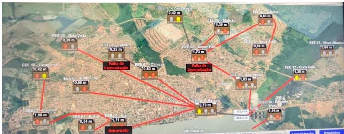
**Figura 10.** Sistema de Monitoramento do Sistema de Esgoto da ETA de Altamira apresentando falhas devido à sobrecarga por operar acima da capacidade em que foi projetado. **Fonte:** Os autores, 2023.
