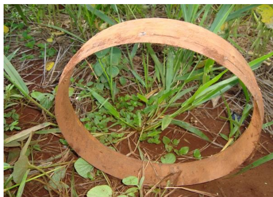
FIGURA 6: Cilindro de metal de 30x5 de altura para a extração do bloco indeformado de terra. FONTE: Silva Júnior (2011).
