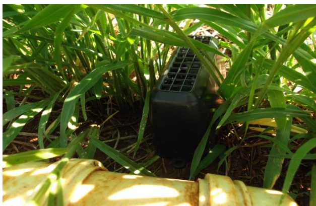
FIGURA 4: Pluviômetros digitais instalados sobre a superfície do solo em cultivo de braquiária.
