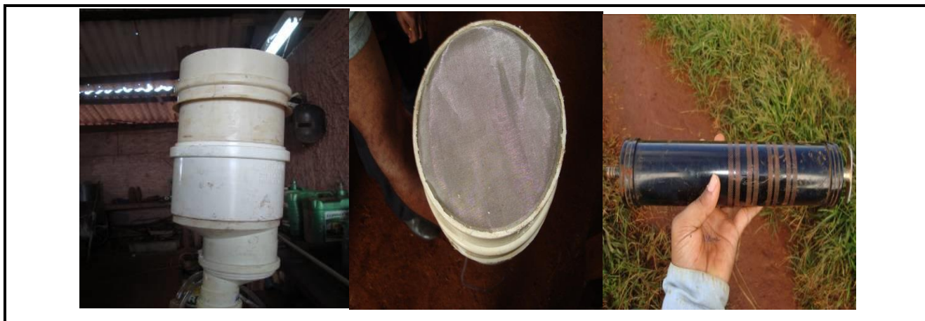
FIGURA 5: A- Modelo de instrumentos pluviométricos manuais; B - Seringa para a retirada da água coletada. FONTE: Silva Júnior (2010).
