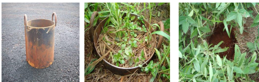
FIGURA 7: A- Cilindro de metal 30X30 de altura utilizado para a extração do bloco indeformado de terra; B- Cilindro de metal 30X30 cravado ao solo; C- Local de onde se retirou o bloco de terra indeformado.
