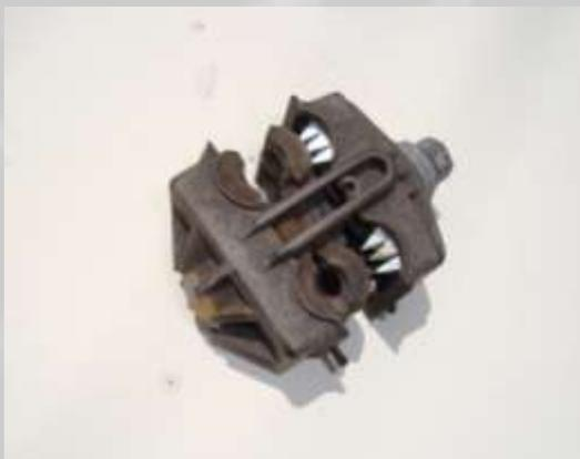
**Figura 1:** O *by-pass*, colocado nos fios de força antes do medidor de energia, tem dentes que “mordem” o fio e fazem um contato direto com a rede da casa. Parte da energia é medida, mas outra parte busca percorrer um caminho mais curto, e assim, a maior parte não é medida, caracterizando o furto, ou a subtração de “coisa móvel”.
