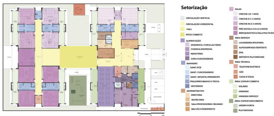
Figura 3: Análise gráfica dos produzida pelos autores. Espaços caracterizados por cores, a partir da planta térrea
