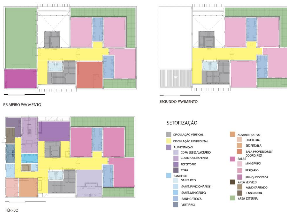
Figura 6: Análise gráfica dos produzida pelos autores. Espaços caracterizados por cores, a partir das plantas dos três pavimentos.
