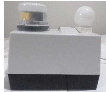
Figura 14b – Relé fotoelétrico ligado a uma lâmpada, montado em uma caixa de contatora elétrica
